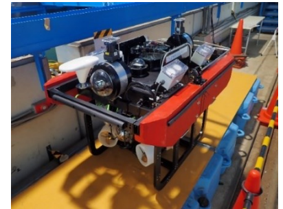
栈橋上部工点検用ROV
