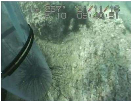
吸引口で詰まる状態
