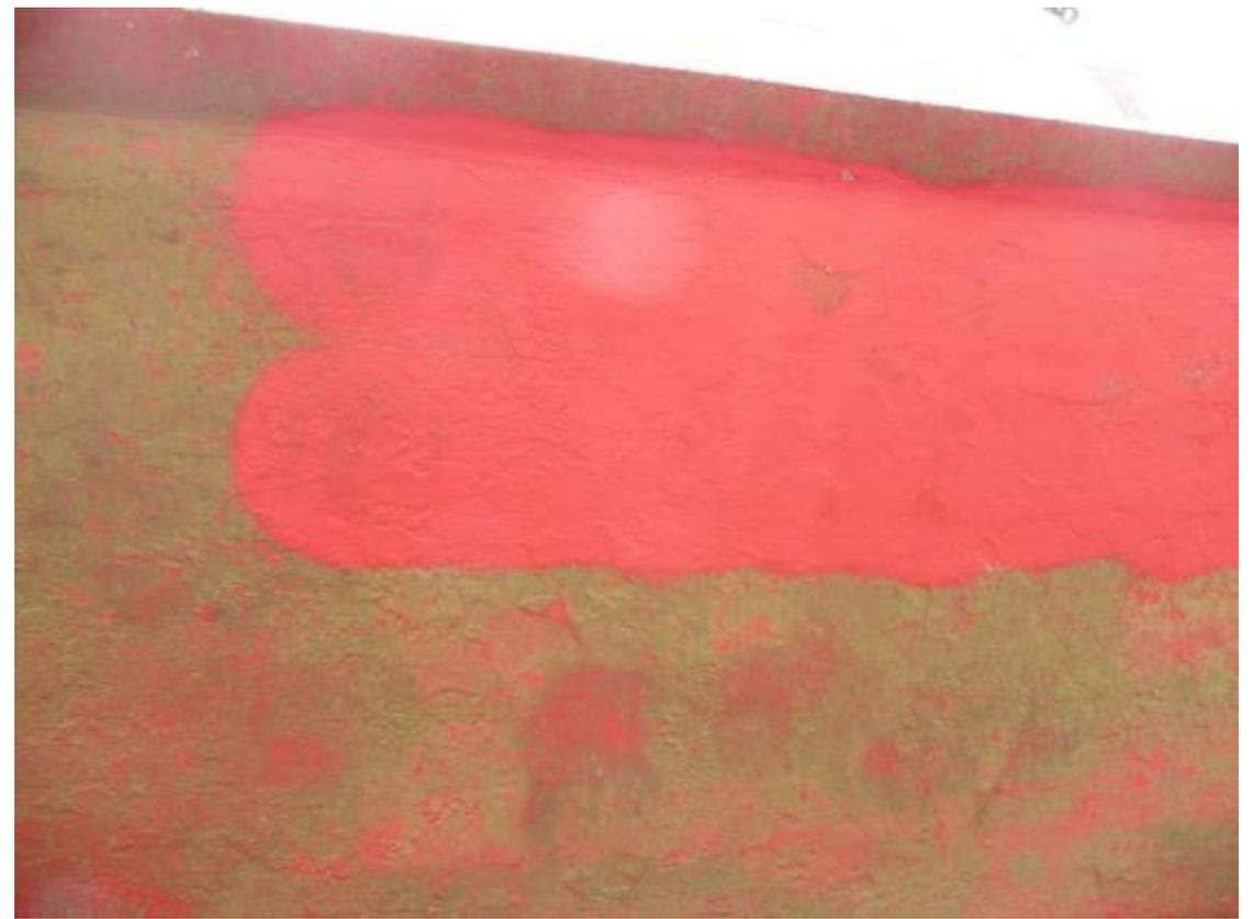
ROVによるAfloatでの清掃
