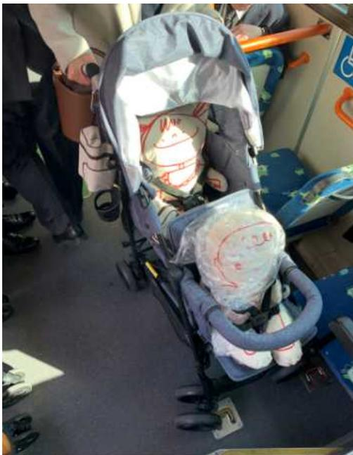
写真 14 座席を跳ね上げて縦型を固定した場合
