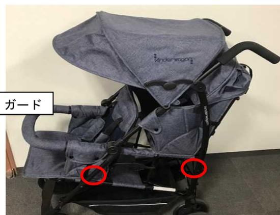
※実証試験でベビーカー固定ベルト（規格ベルト）と車いす横転防止用の補助ベルトを取り付けた位置。ガードには取り付けず、金属パイプへの固定、離れた位置（座面前方と後方のパイプ）への固定が望ましい。また、できるだけ低い位置へ固定することが揺れに対して有利である。
