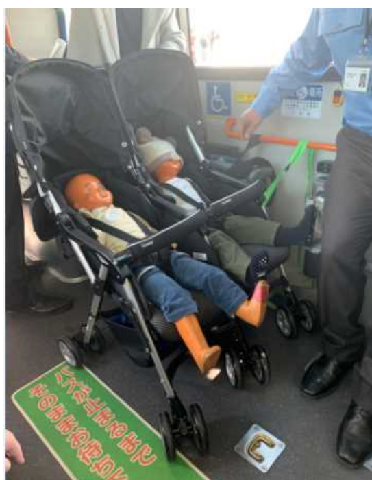
写真 16 車輪をロックしていない場合のベビーカーの状況
