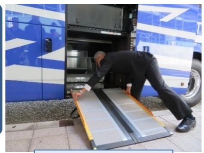
スロープの設置
