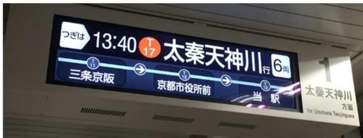
列車の到着時刻と在線位置を知らせる情報提供装置(音声案内対応)
