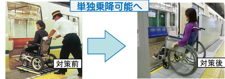
車椅子使用者による実証試験の結果からは、段差2cm・隙間5cm が理想的(全ての被験者が乗降可能)
