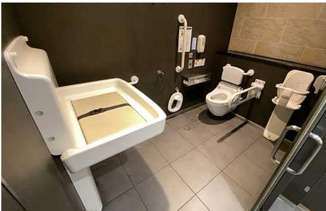
一般トイレ内に設置された車椅子使用者用簡易型便房（おむつ交換台、ベビーチェア、着替え台、幼児用補助便座を設置）。
