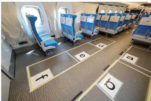
N700S 試験車両を用いた車椅子用フリースペースに関する実証実験の様子
