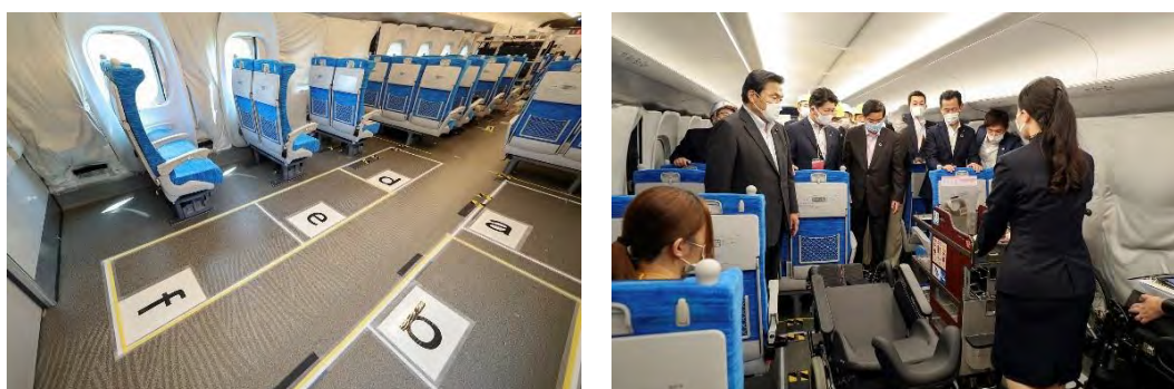
図 3-2 N700S 試験車両を用いた車椅子用フリースペースに関する実証実験の様子
