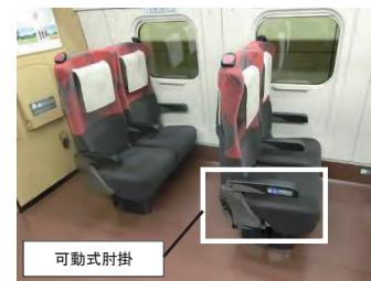
参考 4-1-45：車椅子用フリースペースの例（新幹線の車両）
