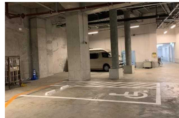
荷捌きスペースの一角に車高2.3mの車両に対応した車椅子使用者用区画を設置
