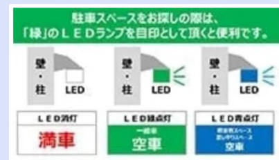
LED照明による満空表示
