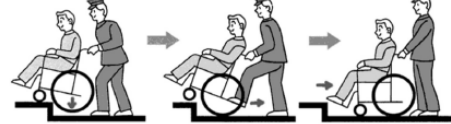
①後輪を下ろす → ②キャストアーを少し浮かせ、後ろに引く → ③キャストアーを下ろす（やや押し気味にするとゆっくり下ろせます）
