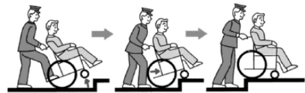
①キャストアーを上げる → ②キャストアーを段に乗せる → ③後輪をゆっくり押し上げる
