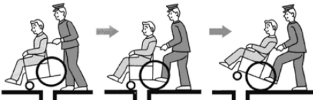
①後輪を浮かせきみにして溝を越える→②そのまま後退し→③わがわが溝にきたら上げて通過する
