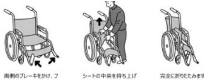
両側のブレーキをかけ、フットサポートを上げます。 シートの中央を持ち上げます（上に引き上げればいすは閉じます） 完全に折りたたみます
