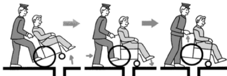
①わがわを上げる → ②溝を通過したらわがわを下ろす → ③後輪を浮かせきみにして溝を越える
