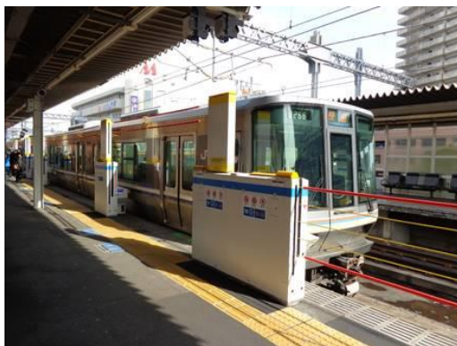
参考 3-1-6：可動式ホーム柵（昇降式）の例
