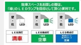
LED照明による満空表示
