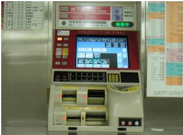
参考 2-3-18：券売機の金銭投入口等を縁取りした例
