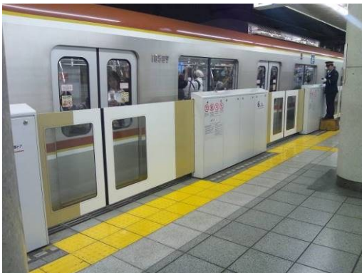
参考 3-1-6：可動式ホーム柵（昇降式）の例
