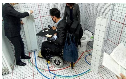
便器へのアプローチ試験の様子 コンセント位置試験の様子 テーブル高さ試験の様子
