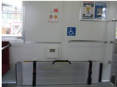
参考 4-1-4：地方鉄道において車両内に渡り板を配備している事例（長崎県 松浦鉄道）
