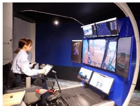
事務所内からの遠隔施工の様子
