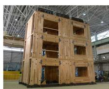
CLTを利用した建築物の実大振動台実験
