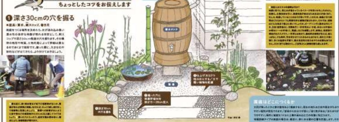
掘った穴に浸透貯留材を深さ15~20cm投入
