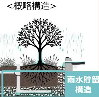
地下に砕石層を設けて、そのうえに土壌や植栽をしつらえることで、植栽枠も含めた施設全体として雨水を貯留浸透する。①と③を組み合わせたような手法として捉えられる。
