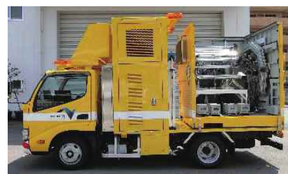
▲ 可視画像撮影及び 3 次元形状計測システムを搭載した車両
