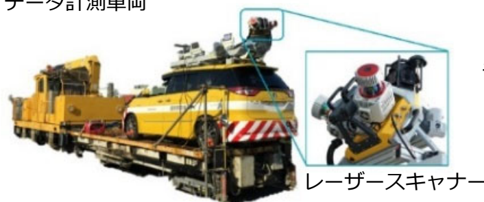
道路用のデータ計測車両を鉄道台車に搭載し、けん引
