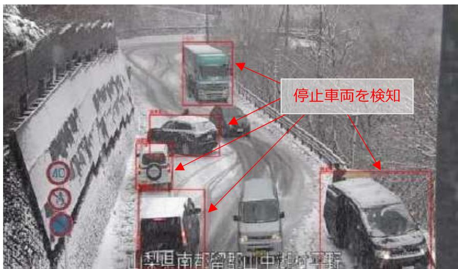
CCTVカメラを用いた交通障害自動検知システム
