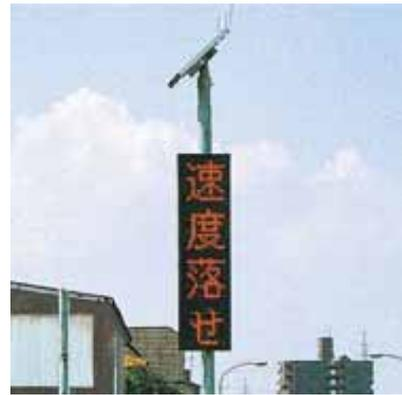
図 7.8.5 視線誘導標の事例(5) [車両誘導発光標識]
