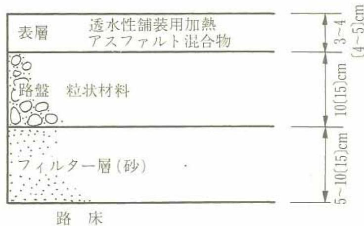
(c) 透水性舗装用加熱アスファルト混合物による舗装構成
