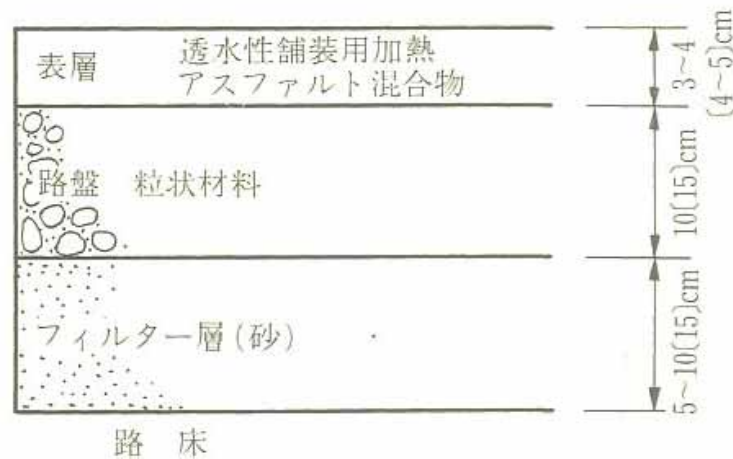
(c) 透水性舗装用加熱アスファルト混合物による舗装構成
