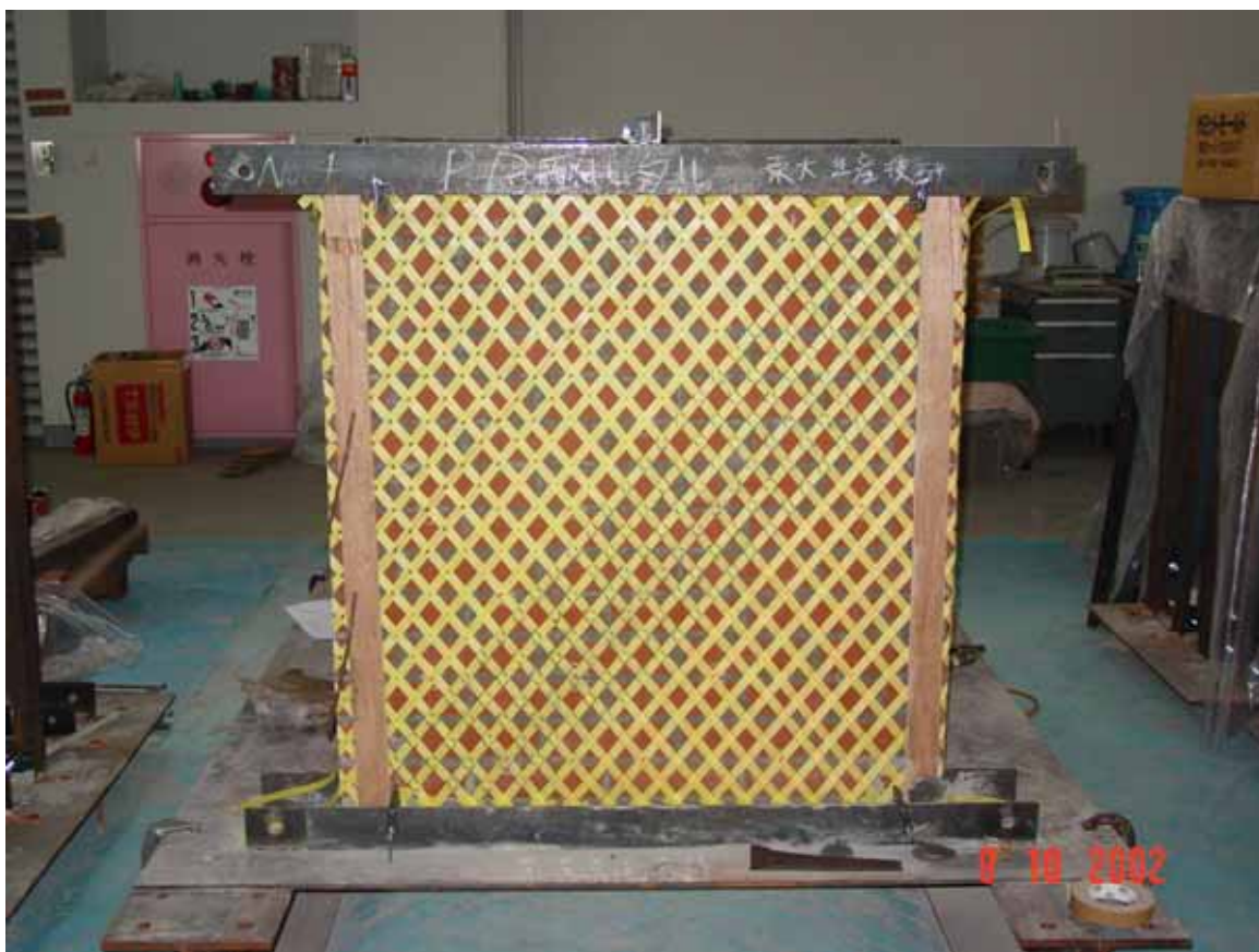
図 3-2-2 P P Bメッシュを設置したレンガ壁試験体
