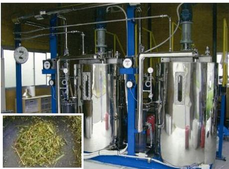
下水汚泥に刈草を混合してバイオマス発電量増加に向けた実証実験 (新潟市)
