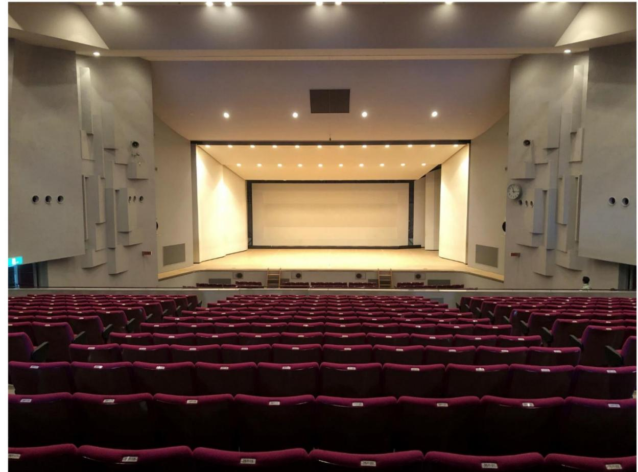
・1967年建築、築53年年度の耐震診断結果から、 $I_s$  値（構造耐震指標）の最小値が0.23で耐震安全性（0.6以上）を満たしておらず、吊天井落下の危険もあることから、令和2年度末をもって休止する予定。
