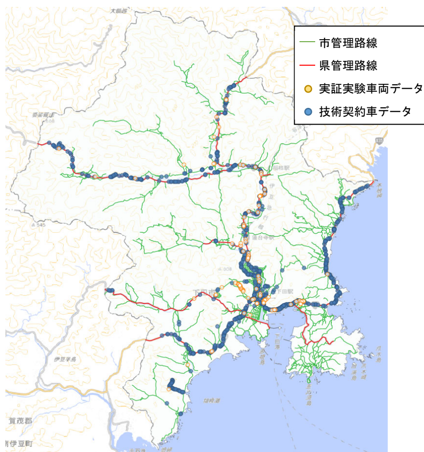
図 4-71. 検知した損傷のマッピング
