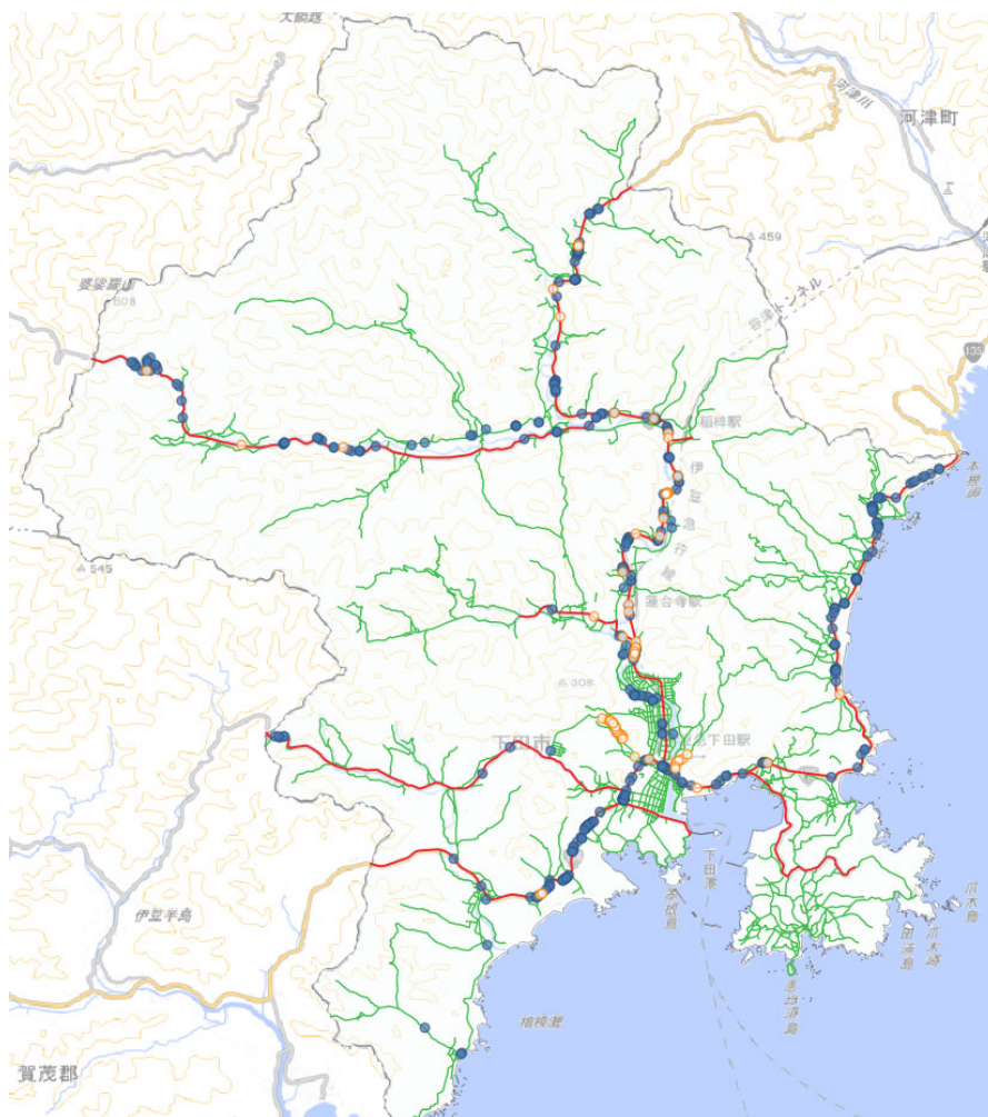
図 4-82. 検知結果(亀甲状ひび割れ、線状ひび割れ、横線状ひび割れ)
