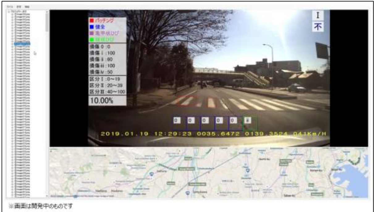
図 5-3 道路巡視支援システム画面（舗装の損傷状況診断）
