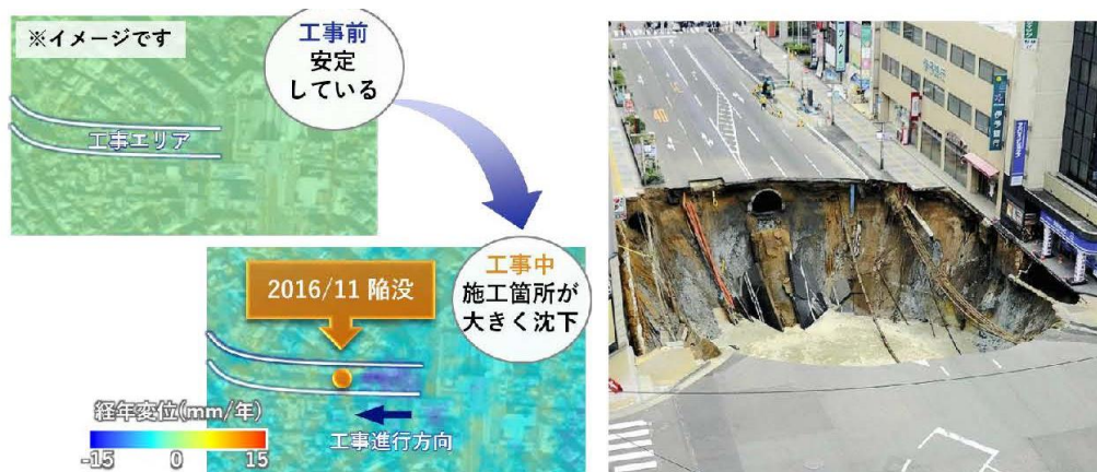
図 5-26 衛星SAR時系列干渉解析結果 (左) と陥没発生時の写真 (右)
