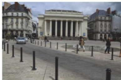
広場の中に設けられた自動車走行レーン 細身のポラードによって歩車は区分されているが、舗装は同素材で、歩車道境界の緑石もない 車が通っていないときは歩行者が横断できるようになっている (フランス・ナント) 出典：名古屋市
