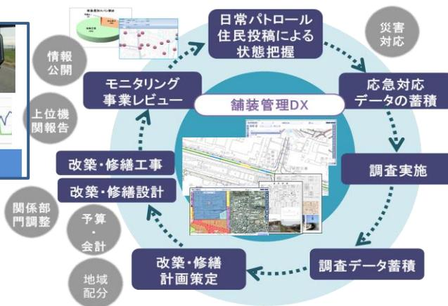
図 舗装管理DXでのメンテナンスサイクル
