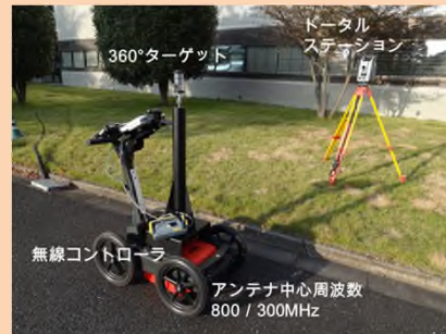
【TS連動型地中レーダシステム】
