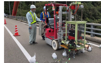
図-3 衝撃荷重載荷試験機「SIVE」の実装
