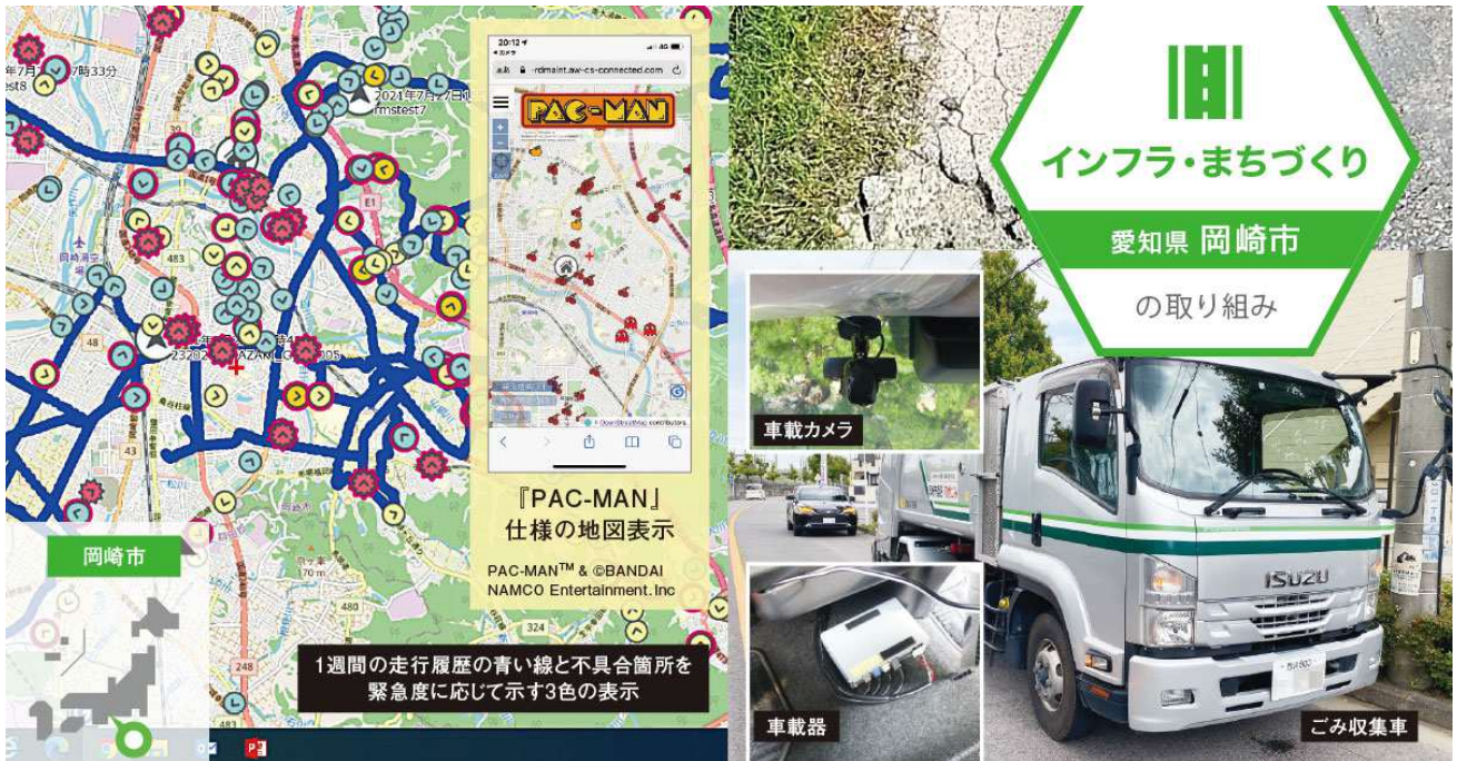
図 11 ゴミ収集車に設置した AI 道路パトロール(岡崎市)
