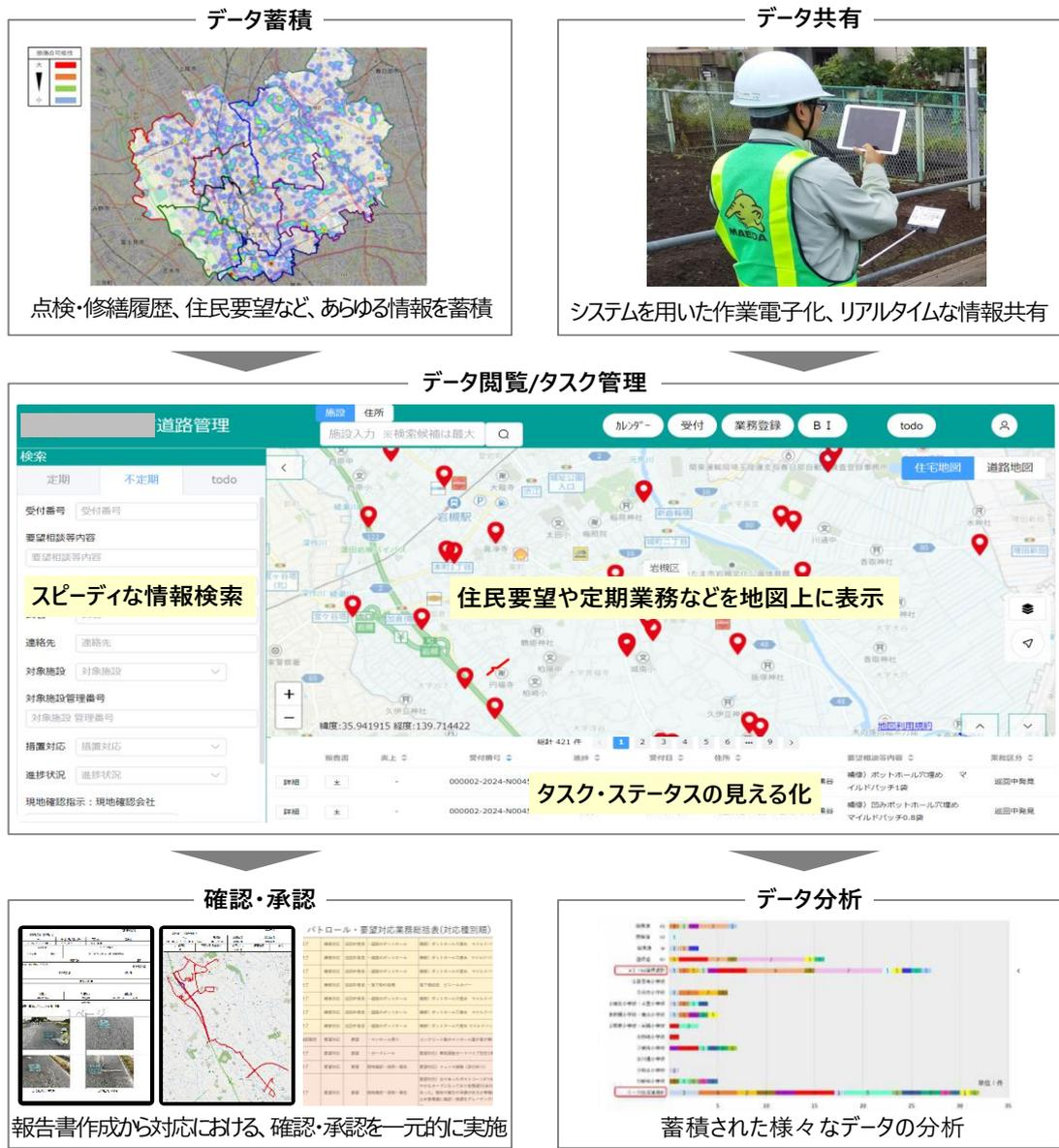
図 5-3-1 インフラ情報管理システムの概要
