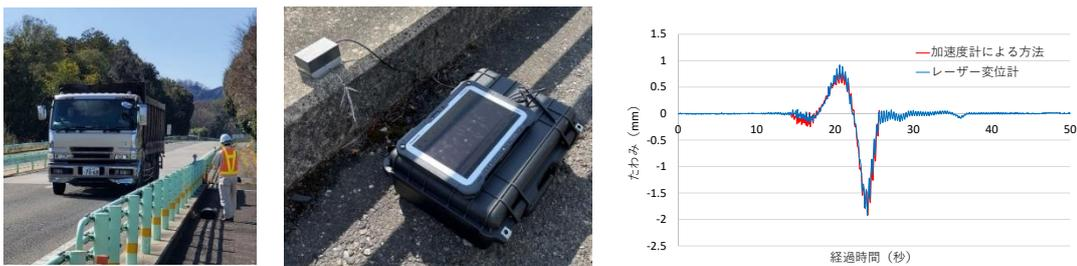
図 5-5-25 加速度計を用いたたわみの計測
