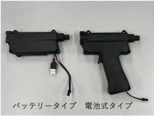
写真-4. 6. 4 打音検査に使用する点検器具
