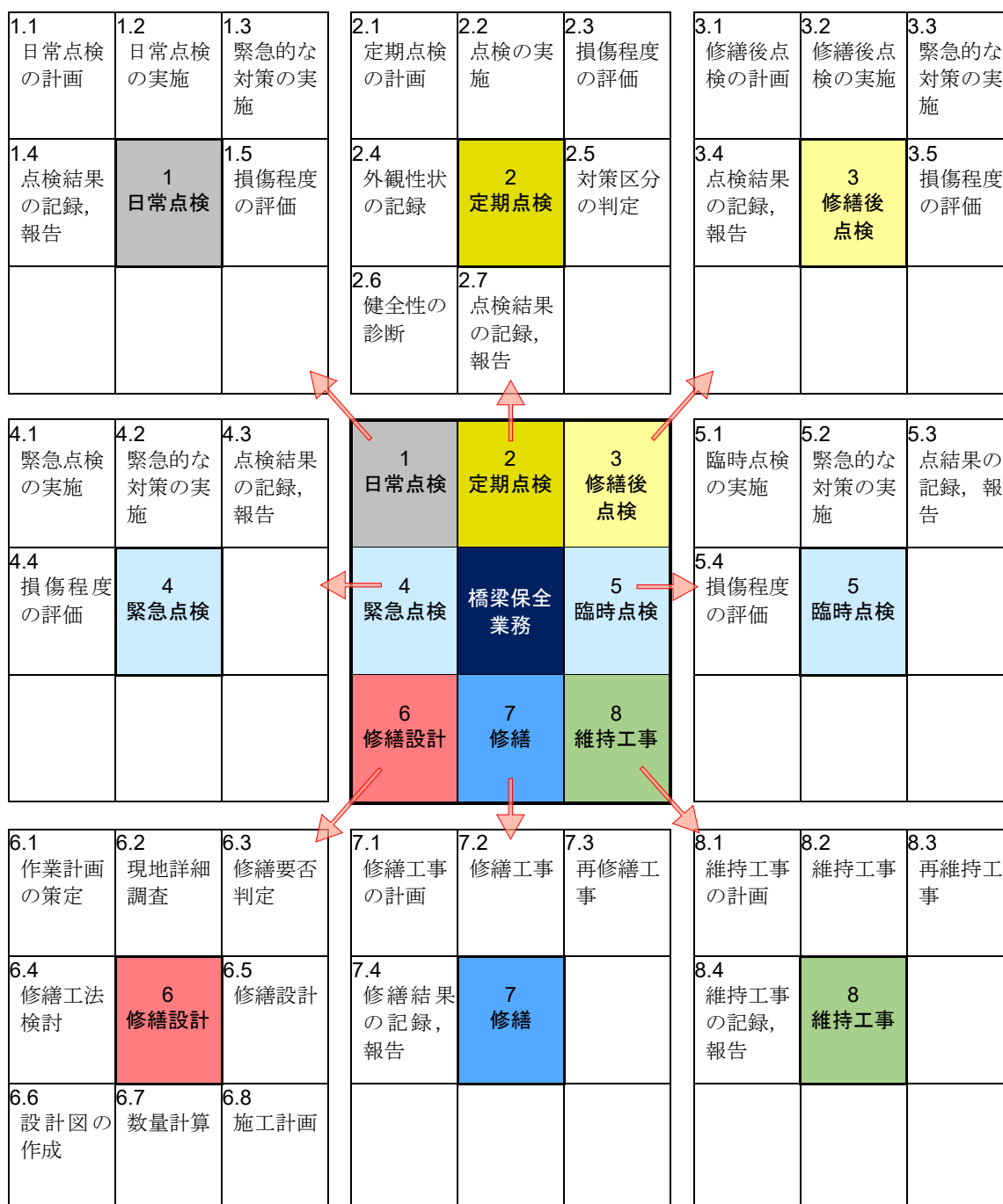
図-3.1.1 DMMによる業務機能構成
