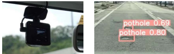
図1 ドラレコ×AIによる路面損傷検出のイメージ
