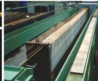
写真-2 AFRPロッドを用いたプレテンション桁製作状況
