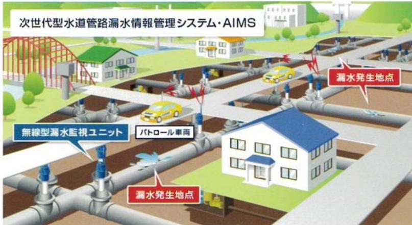
管路劣化診断により選定された危険管路に対し、漏水センサーを設置後、年複数回のパトロール調査（地域事業者）と漏水特定調査（調査専門技術者）を実施
