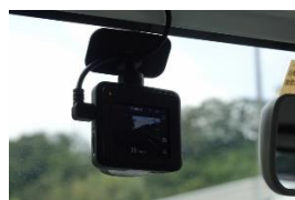
図1 ドラレコ×AIによる路面損傷検出のイメージ
