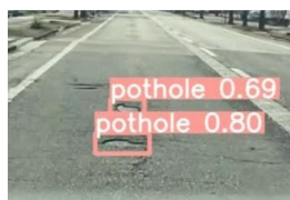
図1 ドラレコ×AIによる路面損傷検出のイメージ
