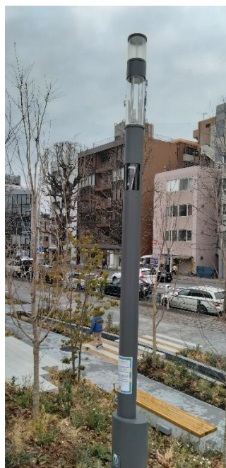
▲ スマートポールに搭載された AI カメラ、ビーコン
