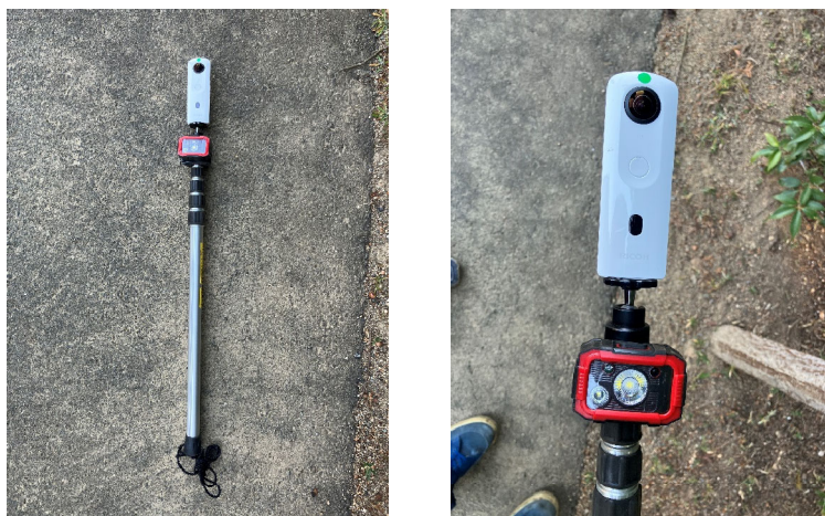
図 5-7 360° カメラとライトを取り付けた点検棒
