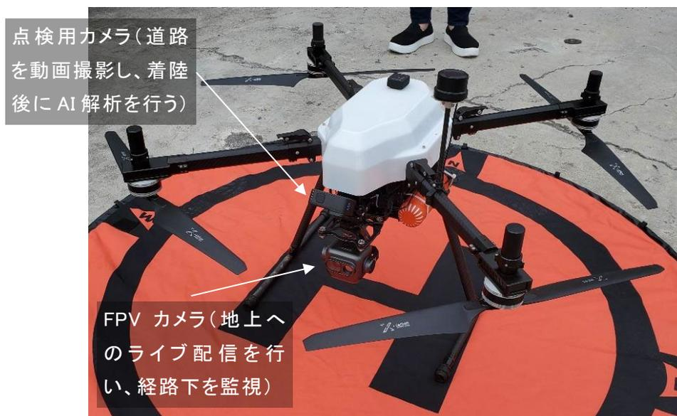
図 8-2 使用機体と搭載機材の構成
