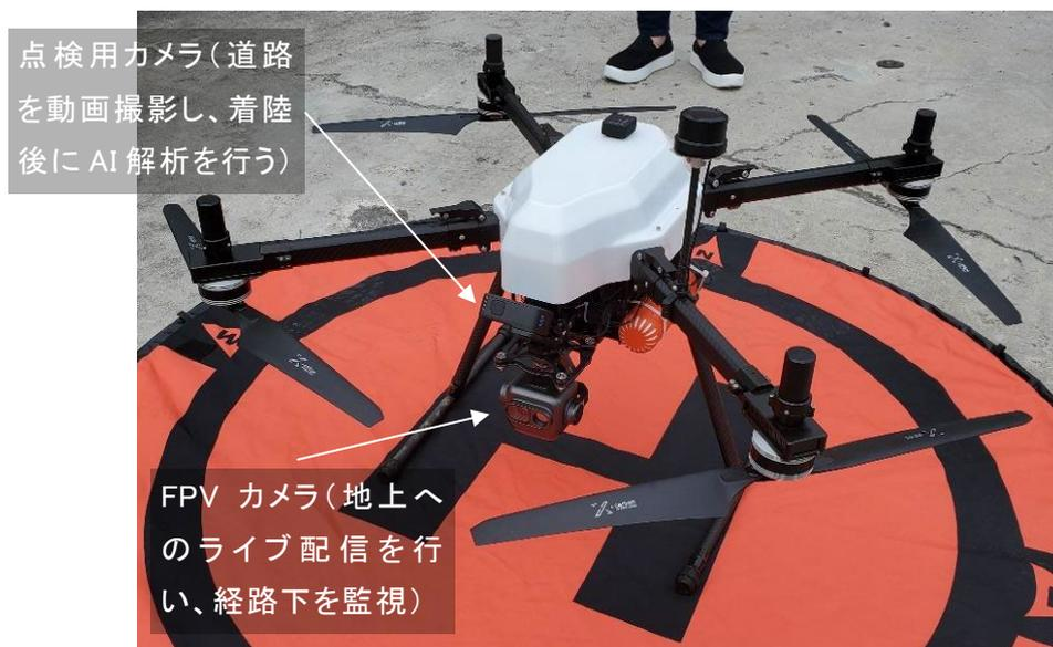
図 5-8 搭載機材の構成
