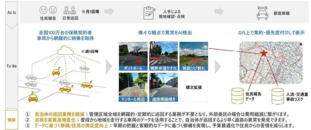
図-2 民間車両の車載カメラ映像分析技術を活用した道路巡回支援サービス
