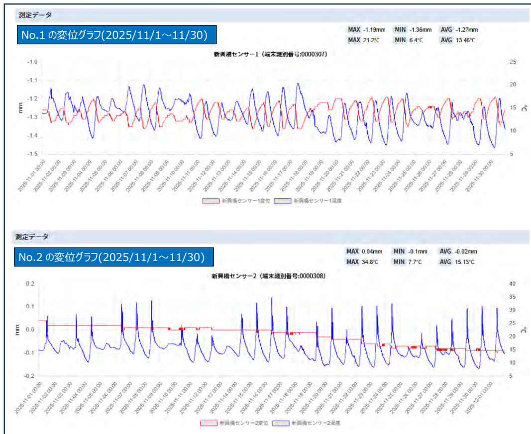
図 4-46 IoT センサーによる変位と温度の観測状況
