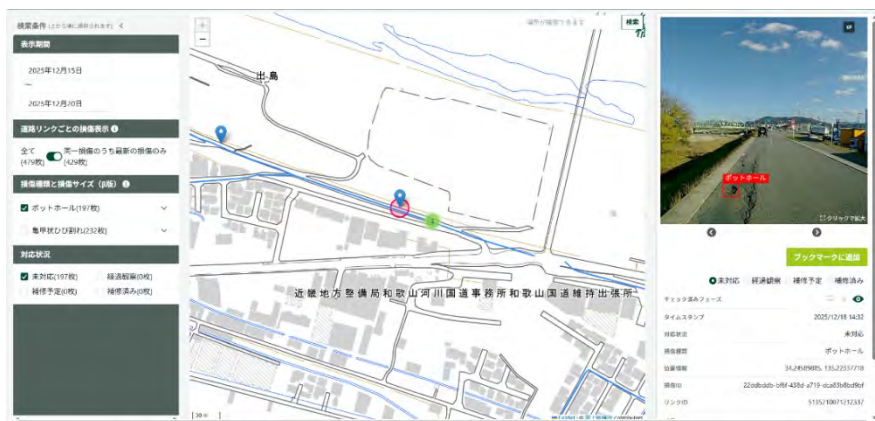
図 4-48 ポットホールの検出状況
