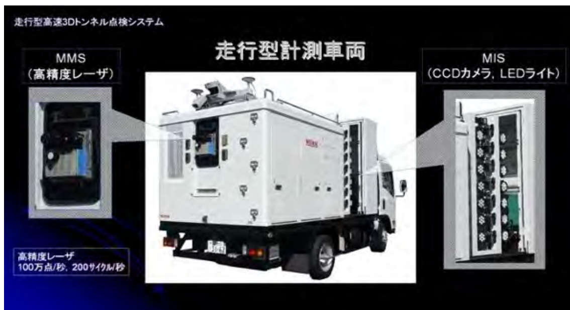
図 4-12 トンネル点検用の MMS 機材と走行状況 (資料：NETIS(新技術情報提供システム))
