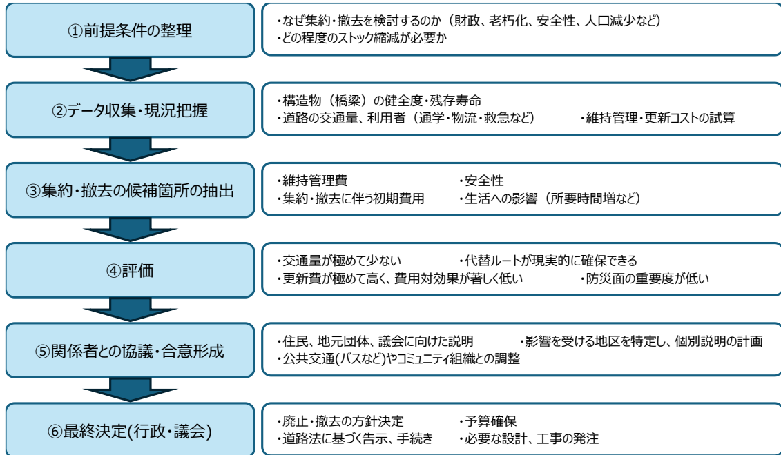
図 4-47 集約・撤去の手順フロー
